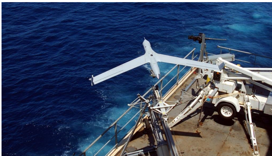
Slika 25. Prikaz ScanEagle BL za vrijeme uzlijetanja na jako malom prostoru
