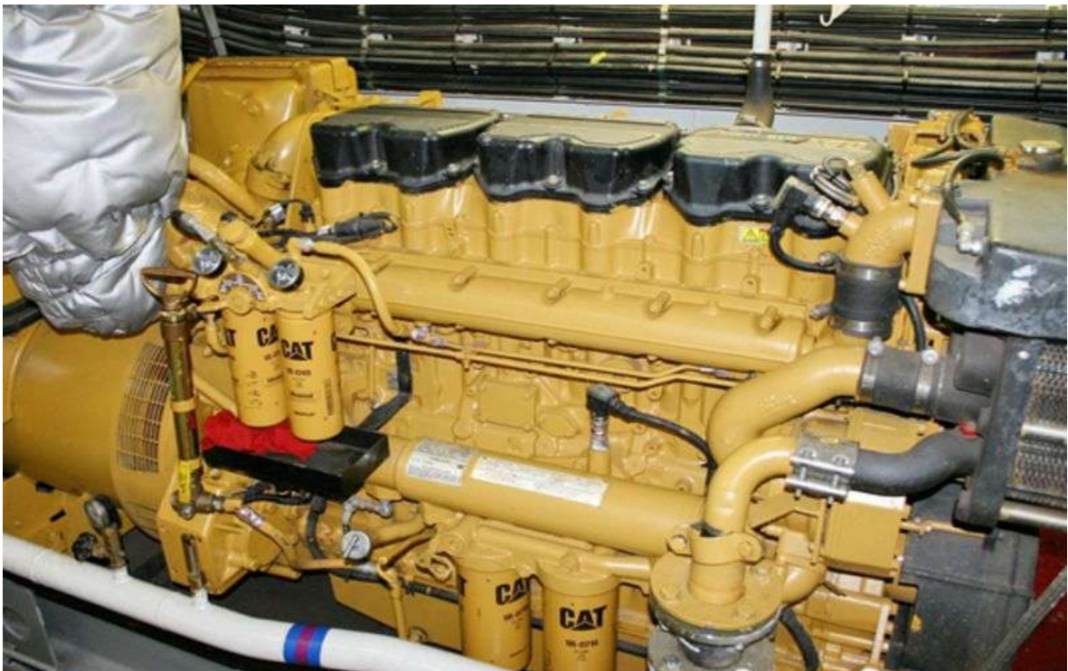
Slika 43. Brodski motor CAT C280-12 4060 kW [27]
