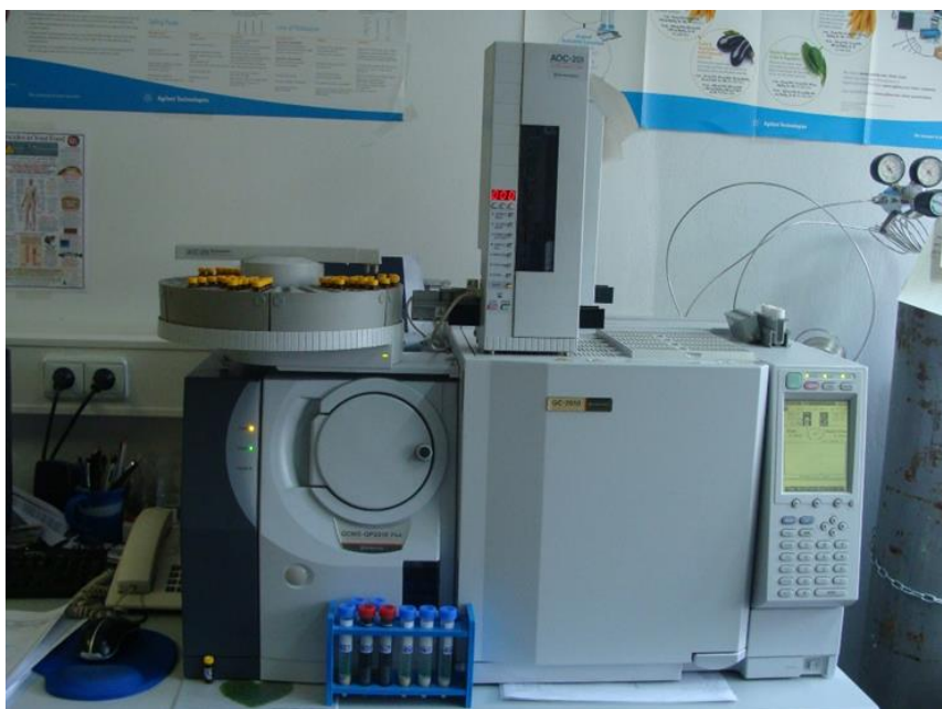
Slika 3. Plinski kromatograf s dvostrukom spektrometrijom masa GC-MS/MS ( Izvor: vlastita fotografija)
