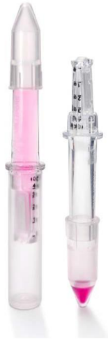
Slika 5. Amicon 10K sustav za ultrafiltraciju (preuzeto s www.merckmillipore.com )
