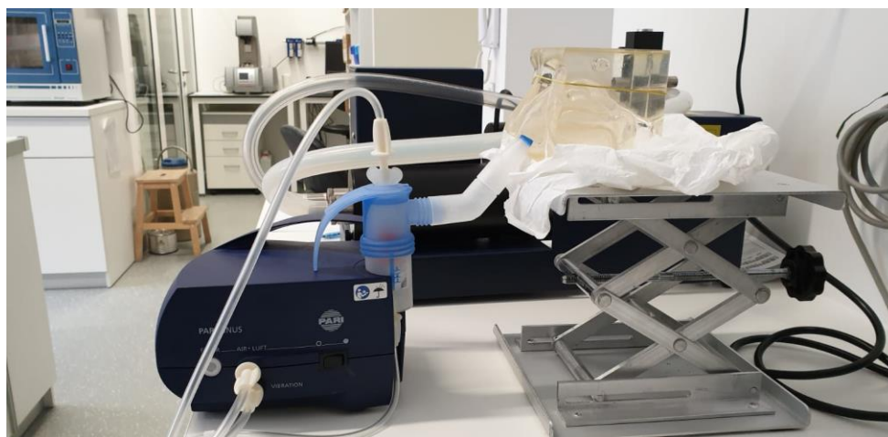
Slika 8. Pulsirajući nebulizator spojen na transparentni model nosne šupljine tijekom ispitivanja profila depozicije in situ gelirajuće nanosuspenzije flutikazonpropionata
