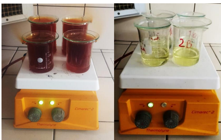
Slika 3. Priprema uzoraka mokrom digestijom
