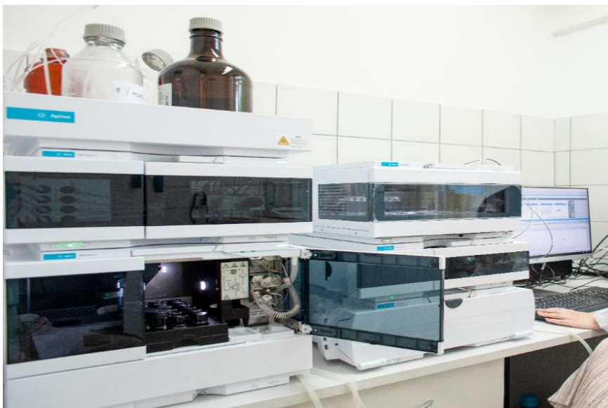
Slika 9. Tekućinski kromatograf visoke djelotvornosti s detektorom s nizom dioda (Izvor: autor)
