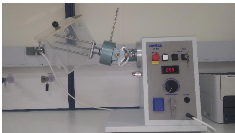
Slika 3. Pogonska jedinica AR 401 (Erweka) s nastavkom za miješanje
