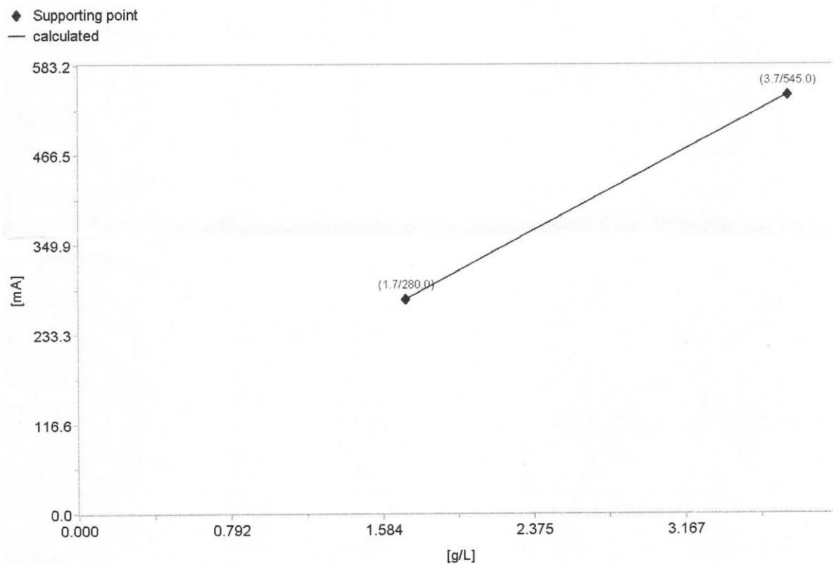
Slika 2. Kalibracijska krivulja odnosa promjene apsorbancije prilikom mjerena protrombinskog vremena i koncentracije fibrinogena u g/L
