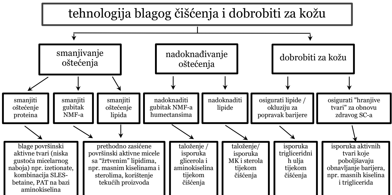
Slika 8. Primjenjivi tehnološki putovi kako bi se proizveo blagi proizvod za čišćenje s hidratacijskim učinkom [8].
