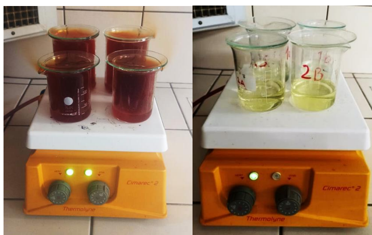
Slika 3. Priprema uzoraka mokrom digestijom
