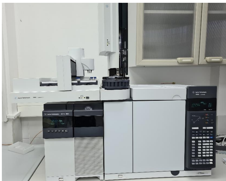
Slika 8. Vezani sustav plinske kromatografije sa spektrometrijom masa (Izvor: autor)
