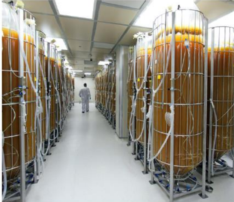
Slika 11 – Bioreaktori s biljnim stanicama u proizvodnom postrojenju Protalix Biotherapeutics ( preuzeto iz 29).
