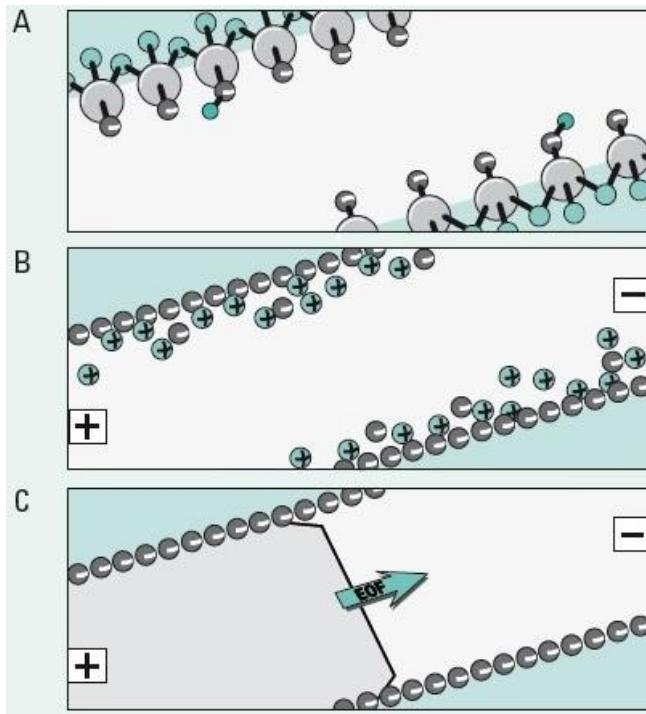
**Slika 3.** Nastajanje elektroosmotskog toka (EOF): **A)** negativno nabijena unutrašnja stijenka kapilare od izvučenog kvarca ( $\text{Si}-\text{O}^-$ ), **B)** kationi privućeni elektrostatskim silama na stijenku kapilare pri čemu se stvara dvostruki električni sloj, **C)** elektroosmotski tok prema katodi.
