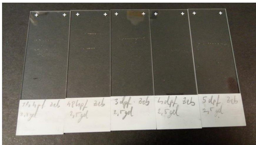
Slika 31. Kriouzorci riba zebrica starosti 1.-5. dana nakon oplodnje inkubirani u otopini 2,5% goveđe želatine i 25% saharoze, uklopljeni u O.C.T. medij, rezani pri optimalnoj temperaturi od -20\text{ }^{\circ}\text{C} i prenešeni na predmetno stakalce presvučeno pozitivnim nabojem.
