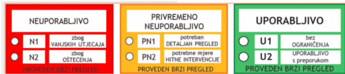
Sl.13. Naljepnice za ocjenu uporabljivosti građevina nakon zagrebačkog potresa
