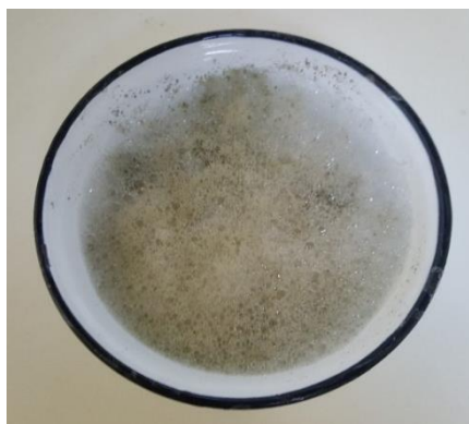
Slika 10. Burna reakcija pod-uzorka s 30% otopinom vodikovog peroksida i natrijevog hidrogenkarbonata.
