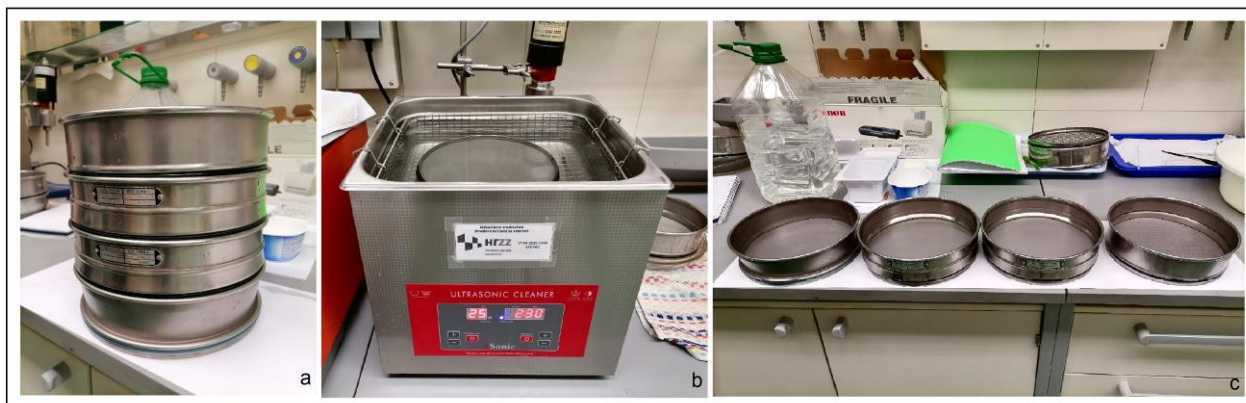
Slika 10: a) Sita poredana od najmanjeg promjera ka najvećem (63, 125, 250, 500 mikrometara); b) Ulrazvučna/ultrasonična kadica; c) Sita pojedinačno.
