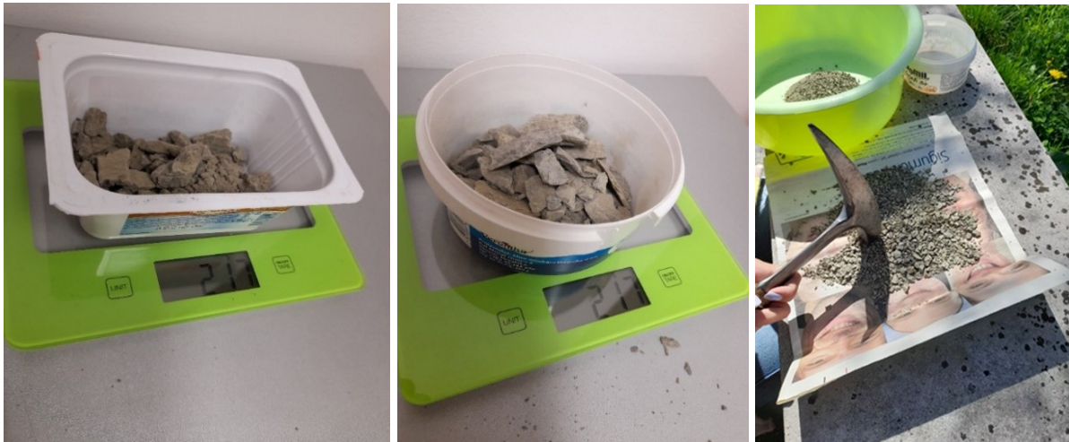
Slika 8.a) Vaganje uzoraka i b) njegovo mehaničko usitnjavanje
