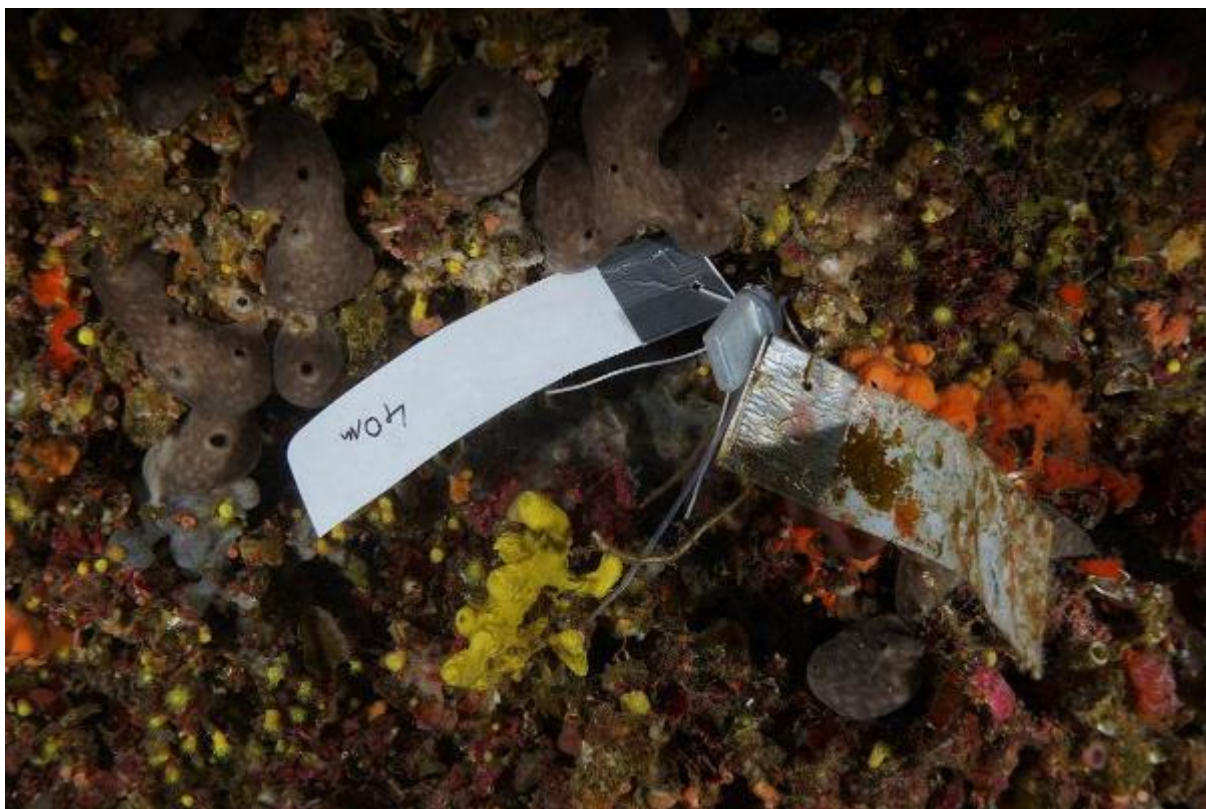
Slika 1. Mjerač temperature mora i količine svjetlosti (Onset Computers data logger) na postaji Rt Lenga.
