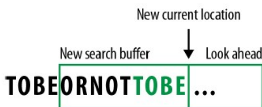
Slika 2.13: Pomak granica pomičnog prozora nakon jednog koraka algoritma LZ77.
