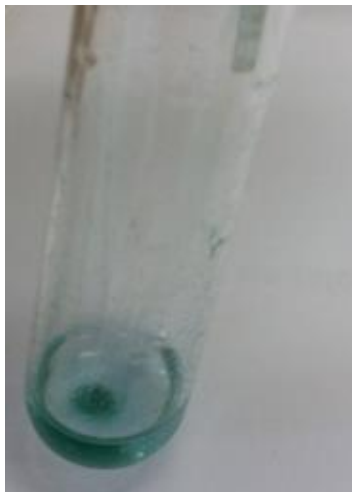
Slika M10. Uočeni zeleni talog nakon dugotrajnog uvođenja cijanovodika
