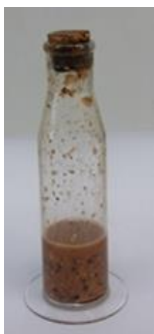
Slika M7. Pripremljena kaša usitnjenih badema s vodom, \text{Na}_2\text{CO}_3(\text{s}) i \text{NaOH}(\text{s})
