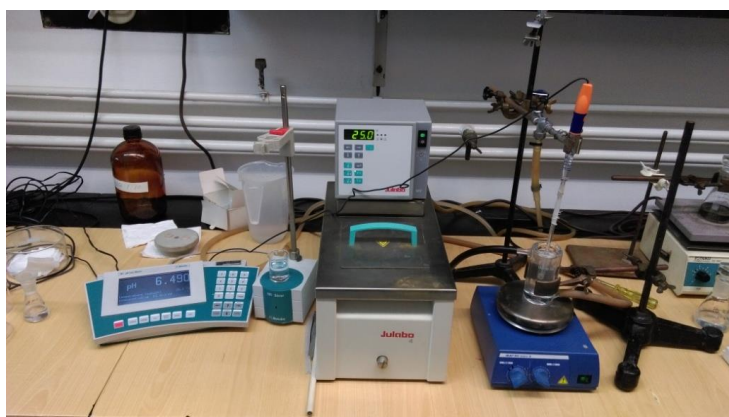
Slika 15. Aparatura za pripremu taložnih sustava i potenciometrijsko praćenje napredovanja reakcije.
