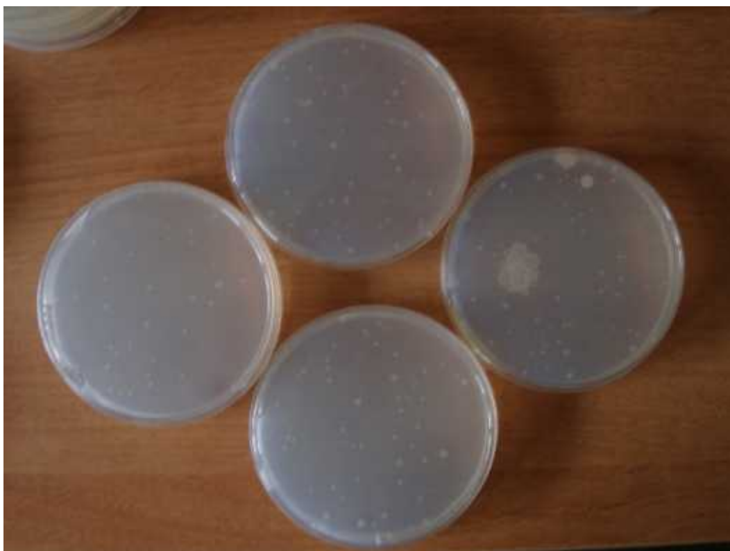
Slika 9. Kolonije soja TA 98 vrste Salmonella typhimurium nakon provedenog Ames testa na uzorcima vode uz metaboli ku aktivnost.
