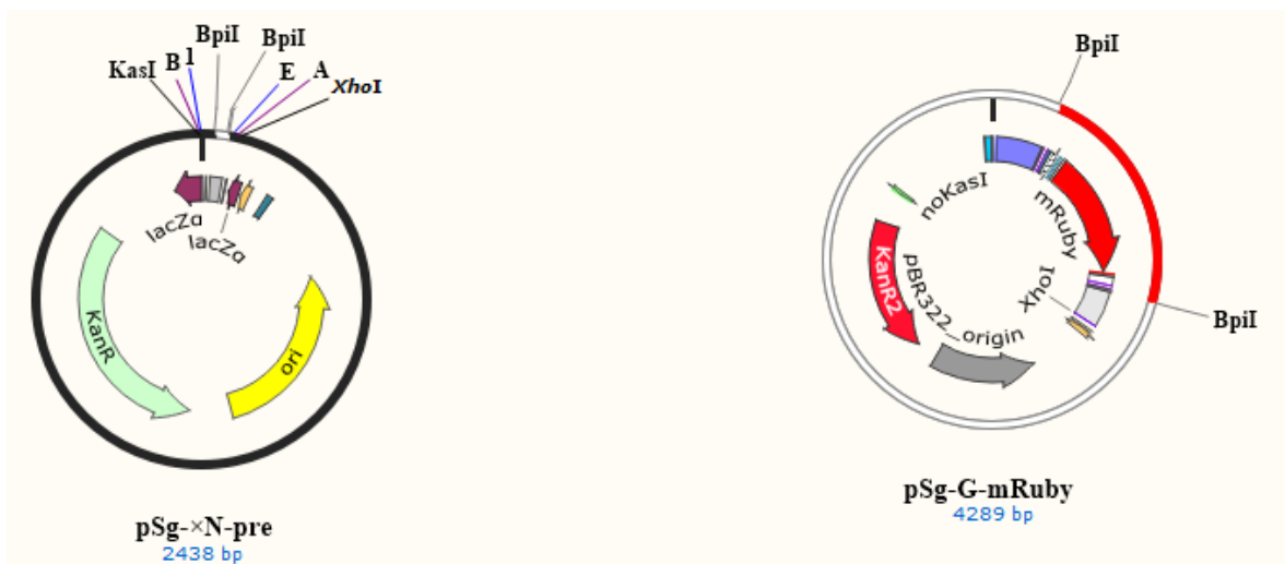
Slika 15. Treći korak u konstrukciji plazmida pSg-xN. U plazmid dobiven u prethodnom koraku, pSg-xN-pre (N=1-6) uvedena je okosnica sgRNA (unutar koje je gen za protein mRuby) iz plazmida pSg-G-mRuby (označeno crvenom bojom). Oba plazmida su pocijepana enzimom BpiI .
