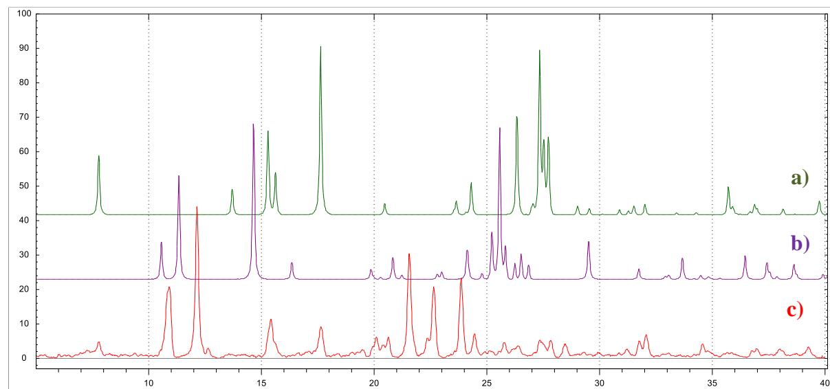
**Slika D6.** Usporedba difraktograma prahova spoja **2a** i polaznih spojeva; a) pirazinamid (**zeleno**), b)  $[\text{Cu}(\text{tfac})_2]$  (**ljubičasto**), c) spoj **2a**, mehanokemijska sinteza (**crveno**)
