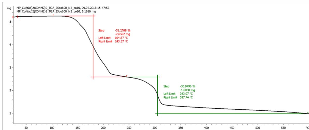
Slika D23. TGA krivulja spoja  $[Cu(\text{tfac})_2(\text{pza})] \cdot \text{MeOH}$  (2a)
