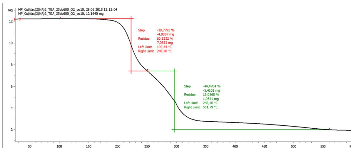
Slika D24. TGA krivulja spoja  $[Cu(\text{tfac})_2(\text{nia})_2]$  (2b)
