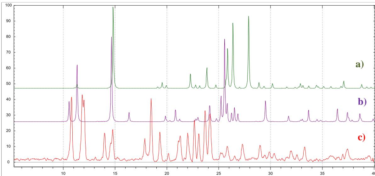
**Slika D 8.** Usporedba difraktograma prahova spoja **2b** i polaznih spojeva; a) nikotinamid (**zeleno**), b)  $[\text{Cu}(\text{tfac})_2]$  (**ljubičasto**), c) spoj **2b**, mehanokemijska sinteza (**crveno**)
