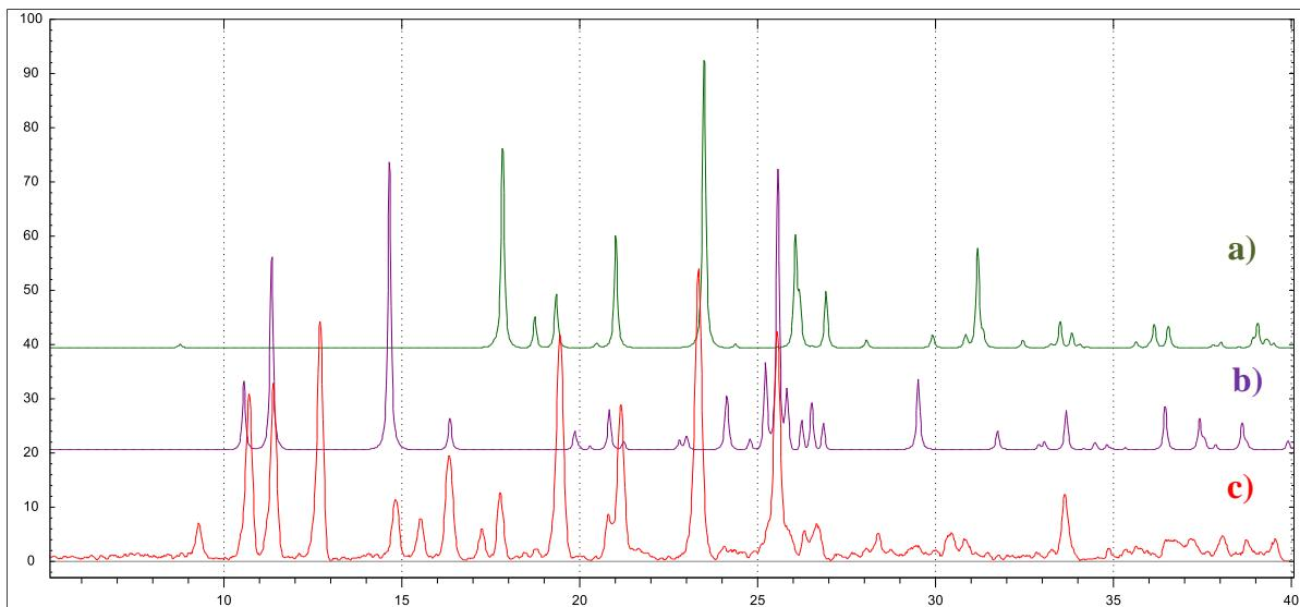
**Slika D10.** Usporedba difraktograma prahova spoja **2c** i polaznih spojeva; a) izonikotinamid (**zeleno**), b)  $[\text{Cu}(\text{tfac})_2]$  (**ljubičasto**), c) spoj **2c**, mehanokemijska sinteza (**crveno**)
