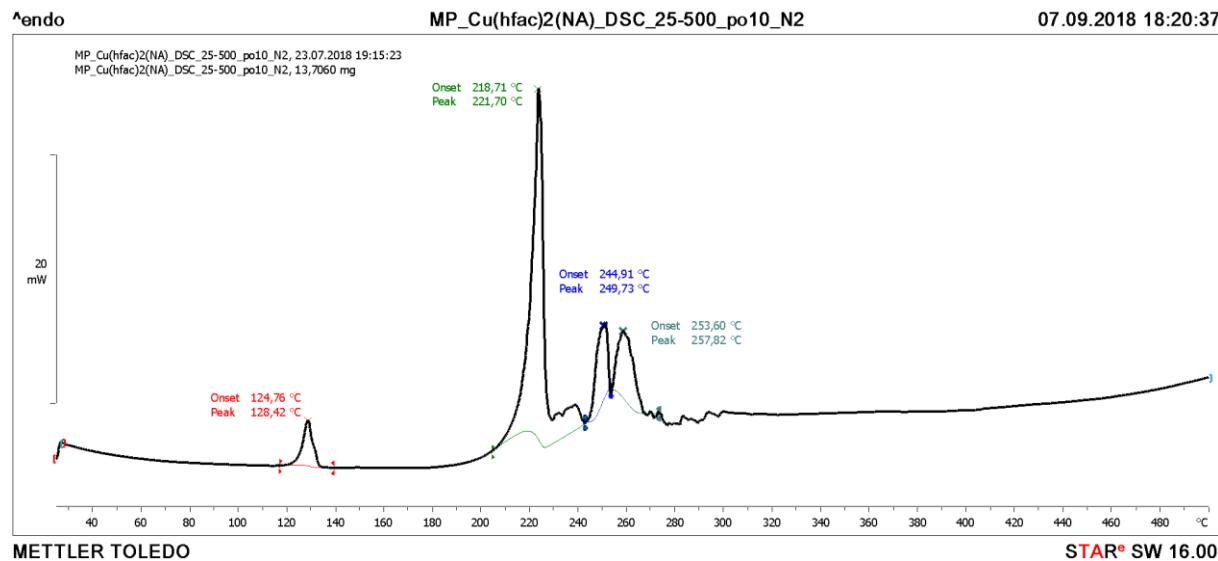
**Slika D27.** DSC krivulja spoja [Cu(hfac)<sub>2</sub>(nia)<sub>2</sub>] (**1b**)
