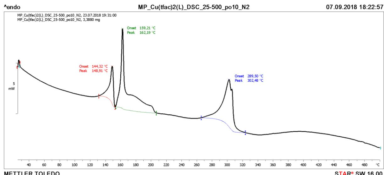
**Slika D28.** DSC krivulja spoja [Cu(tfac)<sub>2</sub>(pza)]·MeOH (**2a**)
