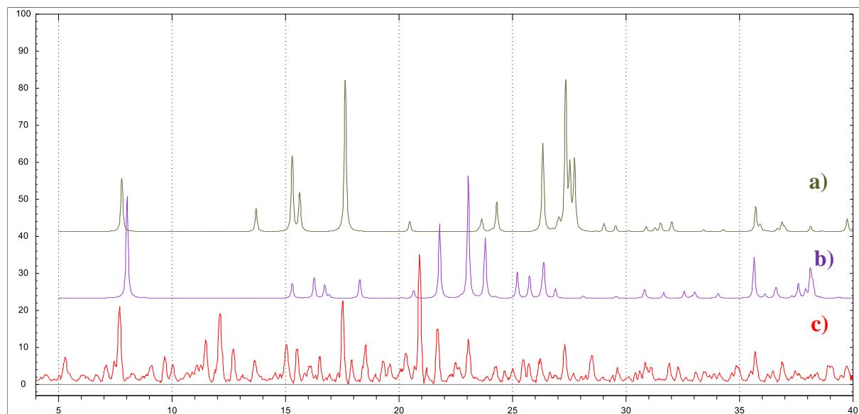
**Slika D2.** Usporedba difraktograma prahova spoja **1a** i polaznih spojeva; a) pirazinamid (**zeleno**), b)  $[\text{Cu}(\text{hfac})_2(\text{H}_2\text{O})_2]$  (**ljubičasto**), c) spoj **1a**, mehanokemijska sinteza (**crveno**)
