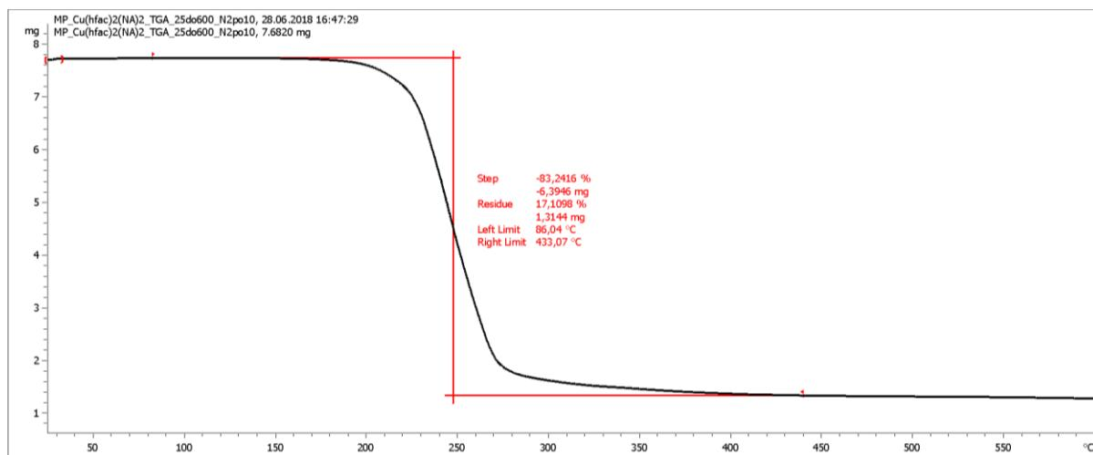
Slika D22. TGA krivlja spoja  $[\text{Cu}(\text{hfac})_2(\text{nia})_2]$  (**1b**)
