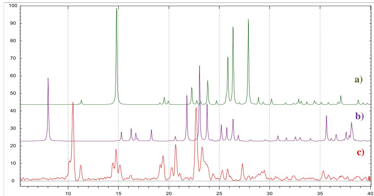
**Slika D4.** Usporedba difraktograma spoja **1b** i polaznih spojeva; a) nikotinamid (zeleno), b)  $[\text{Cu}(\text{hfac})_2(\text{H}_2\text{O})_2]$  (ljubičasto), c) mehanokemijska sinteza spoja **1b** (crveno)
