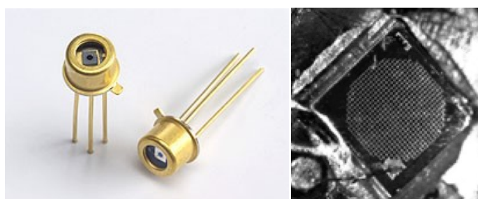
Slika 2.18. SSPM detektor površine 1 \text{ mm}^2 : u TO-46 kućištu (vanjski promjer 4.72 \text{ mm} ) (lijevo); uvećana slika aktivnog dijela površine na kojem se vidi mnoštvo piksela dimenzija 20 \text{ }\mu\text{m} \times 20 \text{ }\mu\text{m} . Prikazan je model SSPM_0701BG švicarske tvrtke Photonique SA [27].
