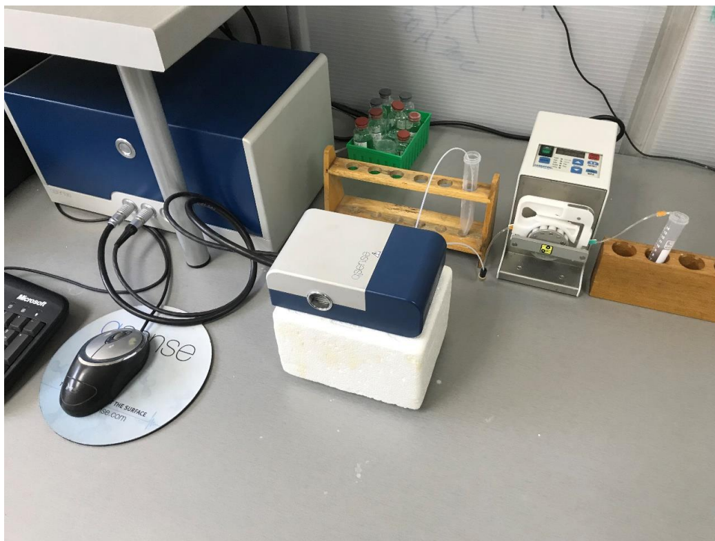
Slika 12. Kvarc kristalna mikrovaga s praćenjem disipacije, Q-Sense E1, Biolin Scientific, Švedska.
