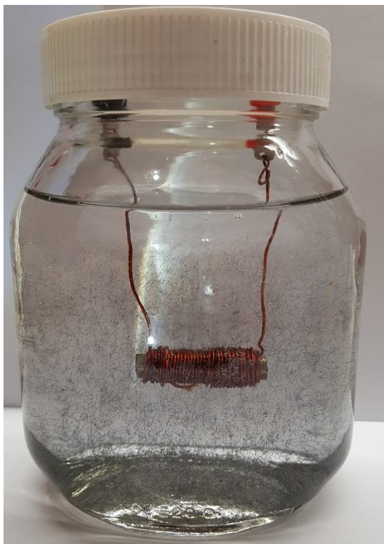
Slika 22 Zavojnica u mineralnom ulju s usitnjenom čeličnom piljevinom
