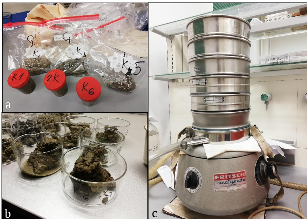
Slika 8 (a) Uzorci površinskih 2 cm sedimenta korišteni za granulometrijsku analizu i (b) osušeni uzorci korišteni za prosijavanje kroz (c) set Retsch® ASTM sita
