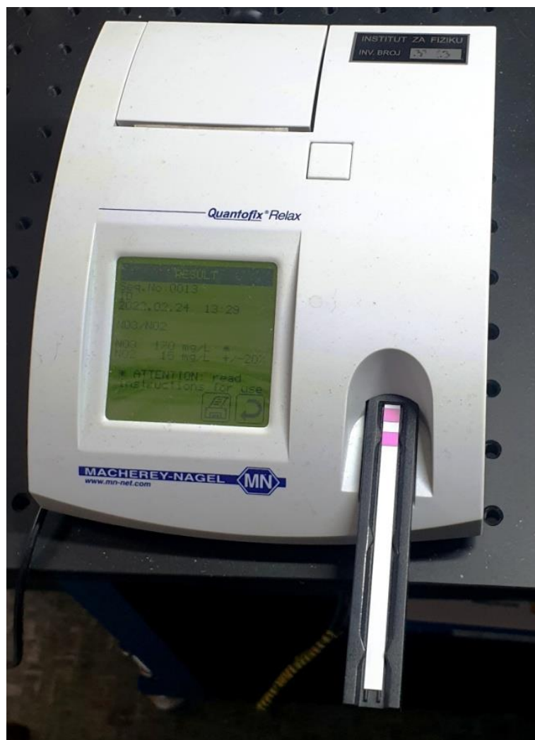
Slika 5.7. Fotografija analize nitrit/nitrat testne trakice QUANTOFIX® Relax uređajem
