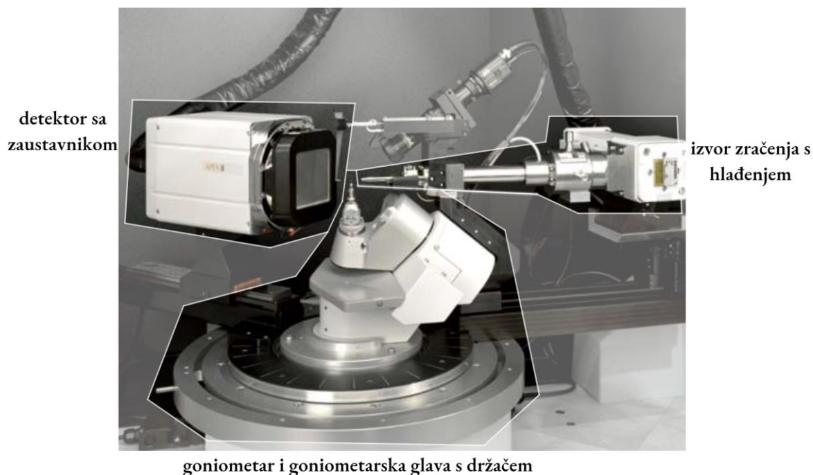
Slika 8. Fotografija difraktometra za difrakciju rendgenskih zraka u monokristalu, slika preuzeta i prilagođena prema izvoru 19
