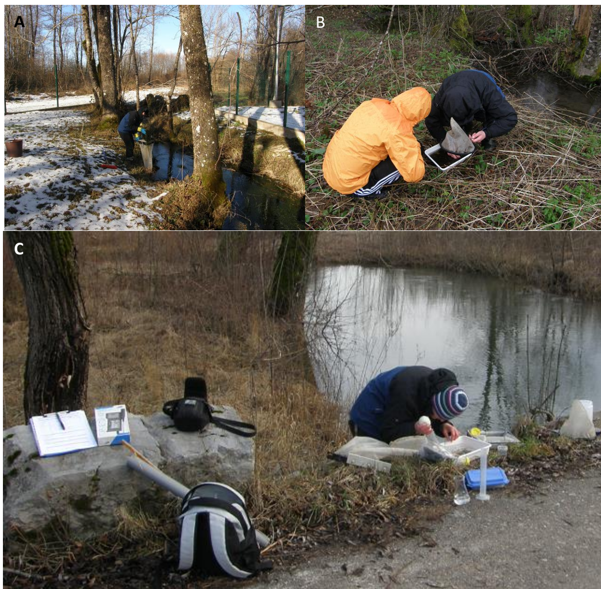
Slika 13. Metodologija terenskih istraživanja na izvoru i izvorišnom toku Mrđenovac: A) korištenje kracer mreže 25 \times 25 cm (05.01.2015.); B) provjera prikupljenog uzorka i otklanjanje anorganskog i organskog materijala; C) prikaz korištene terenske opreme (obrazac, fotoaparati, dubinomjer, set za titraciju, kracer, bentos mreža i kadica te velika kapalica za odvajanje rijetkih primjeraka faune za potrebe fotografiranja ili odvojenog konzerviranja) (foto. Ivica Barača i Sanja Gottstein).
