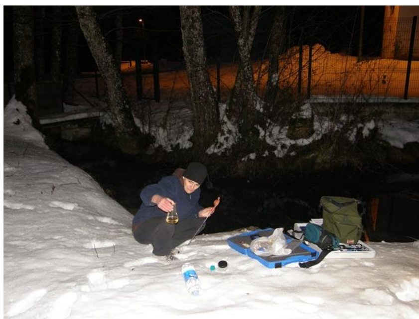
Slika 12. Titriranje vode na izvoru Mrđenovac u svrhu određivanja alkaliniteta (30.11.2015.) (foto. Ivica Barač).
