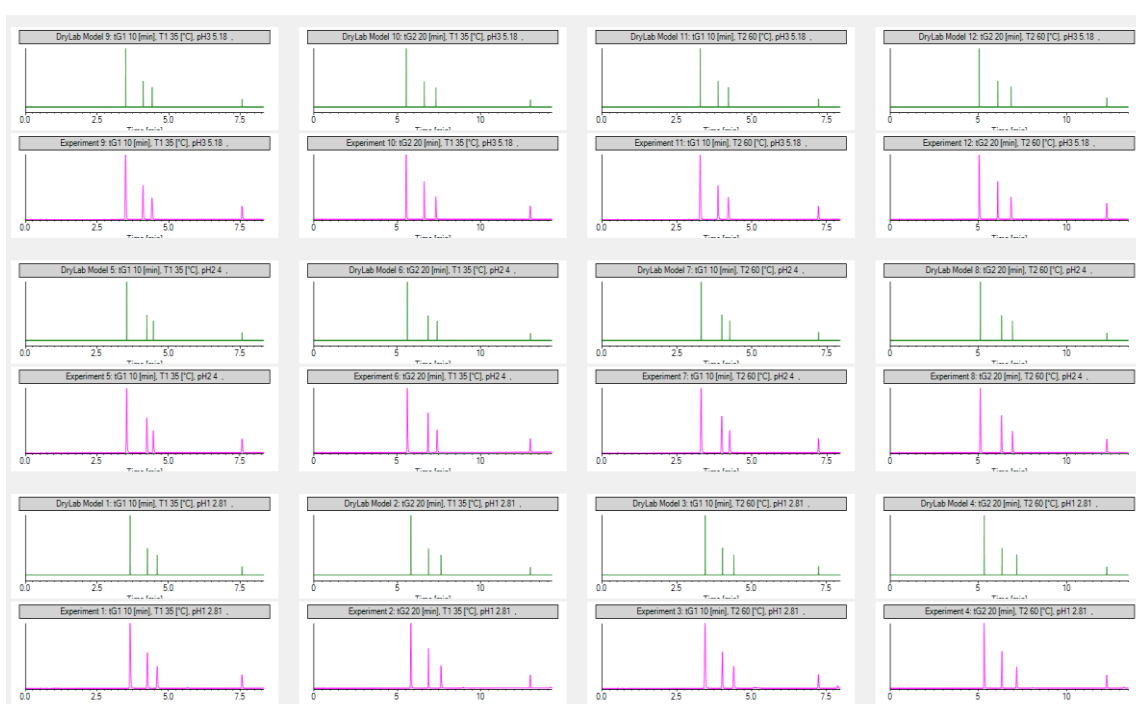
Slika 31: Usporedba kromatograma dobivenih DryLab modelom (zeleno), i eksperimentalnim putem (roza)
