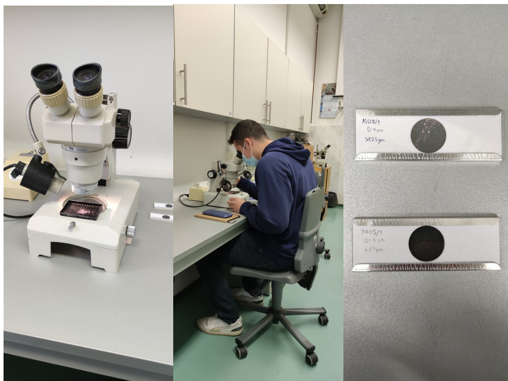
Slika 3. Izdvajanje foraminifera pomoću stereoskopskog mikroskopa Nikon u Franckove ćelije u Geološko-paleontološkom zavodu (Izvor: vlastita fotografija)
