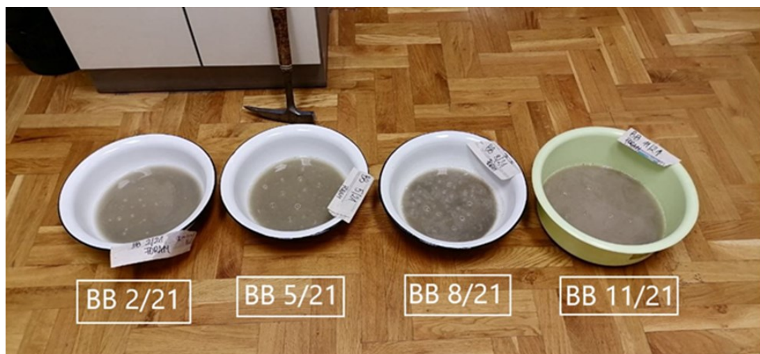
Slika 10. Reakcije uzoraka nakon dodavanja otopine vodikovog peroksida
