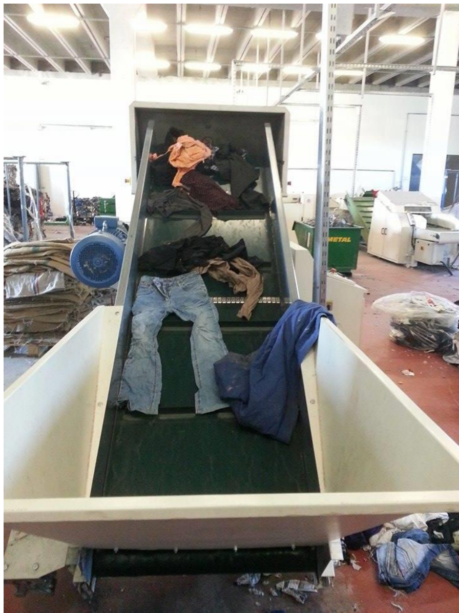
Slika 6. Stroj za usitnjavanje odjevnih predmeta koji i odvaja gumbe, metalne dijelove i sl. koji ne smiju ući u iduću fazu obrade.
