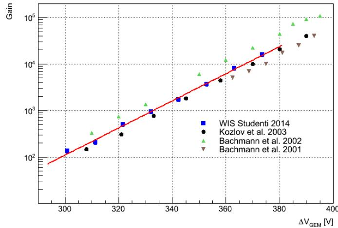
Slika 4.5.: Mjerenja faktora pojačanja (Gain) sa trostrukim GEM detektorom u mješavini Ar-CO<sub>2</sub> 70-30 i usporedba sa već objavljenim rezultatima.
