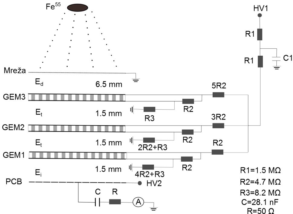
Slika 4.11.: Predložena shema za mjerjenje povratne struje iona.
