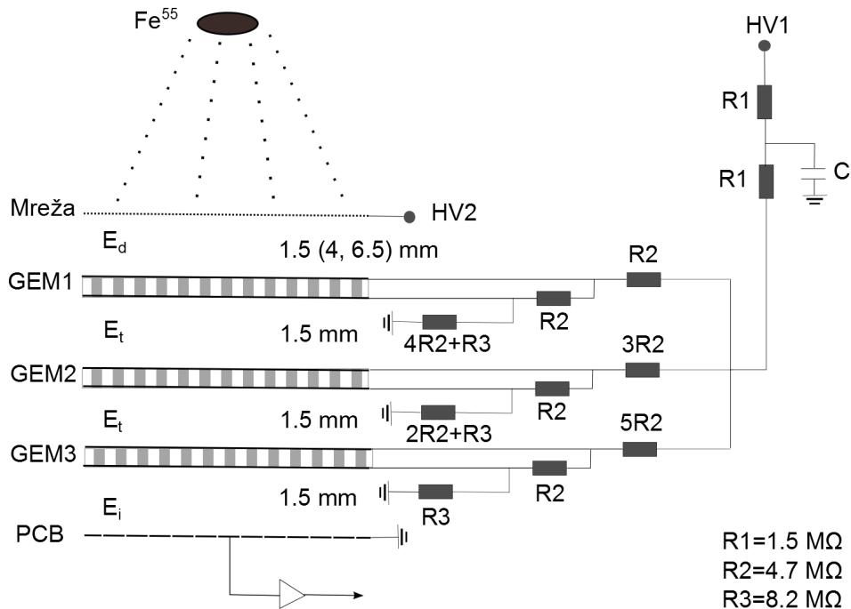
Slika 4.1.: Shema eksperimentalnog postava mjerjenja sa 3GEM detektorom.
