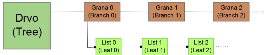
Slika A.2.: Drvenasta struktura podataka u dokumentu tipa root.
