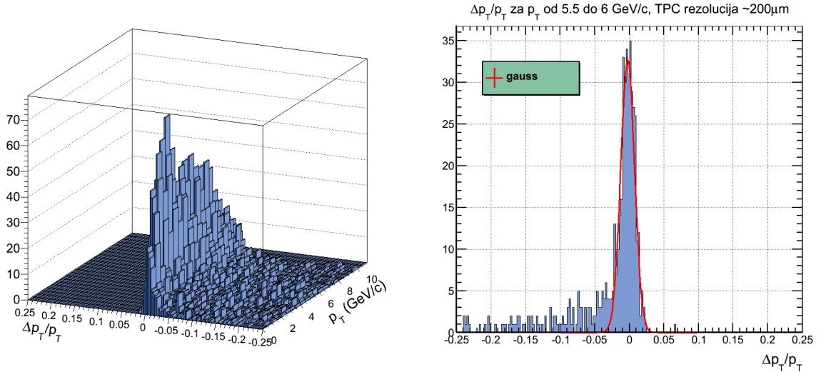
Slika 3.1.: Dvodimenzionalna raspodjela rezolucije i generiranog impulsa elektrona (lijevo). Projekcija na y-os te raspodjeli za  $p_T$  od 5.5 do 6 GeV/c (desno).
