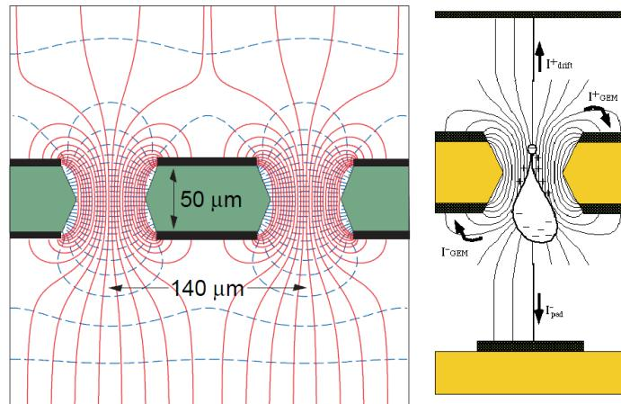
Slika 2.4.: Karakteristične dimenzije GEM folije (lijevo) i prikaz lavine u jednoj od rupica (desno). Oblik kapljice dolazi od različite pokretljivosti iona i elektrona (ioni su znatno sporiji).
