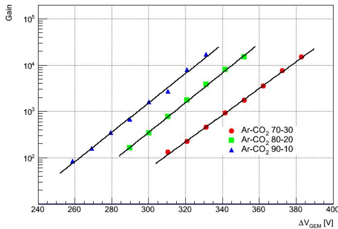
Slika 4.6.: Usporedba mjerena faktora pojačanja u tri različite mješavine plinova Ar i CO<sub>2</sub>.
