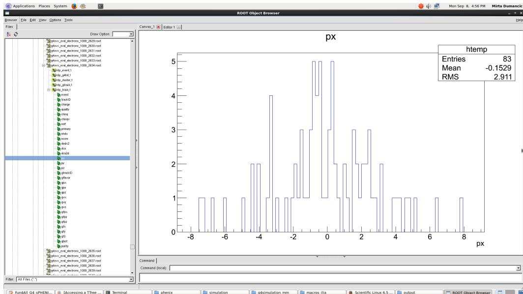
Slika A.3.: Drvenasta struktura dokumenata koji je rezultat konkretne simulacije rada TPC detektora za sPHENIX. Prikazana je raspodjela događaja za raspon impulsa u x smjeru od -8.5 GeV/c do 8.5 GeV/c.
