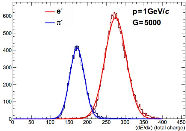
Slika 2.6.:  $dE/dx$  spektar elektrona i piona impulsa  $1\text{ GeV}/c$  mjerен на prototipu unutarnjih komora za očitavanje ALICE detektora sa trostrukim GEM folijama za multiplikaciju signala [41].
