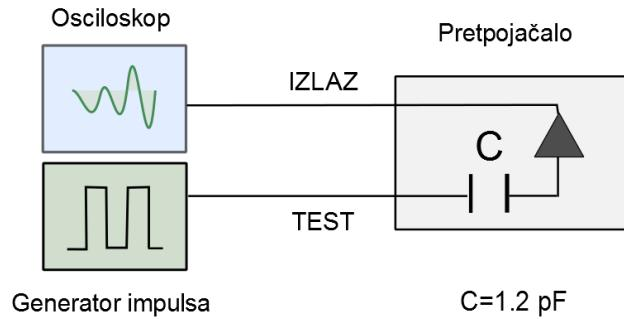
Slika 4.4.: Shema za kalibraciju predpojačala.
