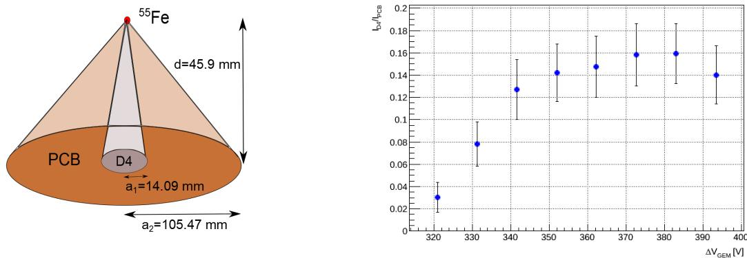
Slika 4.9.: Shematski prikaz zračenja iz izvora na tiskanu ploču u aproksimaciji točkastog izvora i kružne plože (lijevo). Omjer struja sa cijele tiskane ploče i struje sa jednog od središnjih heksagonalnih dijelova (desno).
