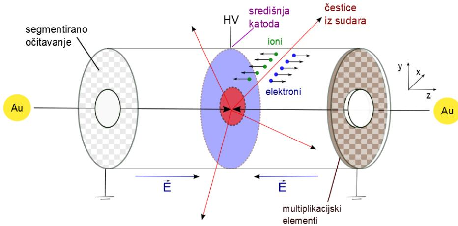
Slika 2.2.: Shematski prikaz i ilustracija principa rada komore vremenske projekcije.
