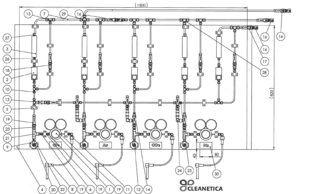
Slika 4.3.: Schema plinskog sustava koji osigurava dovod i protok plina kroz detektor.
