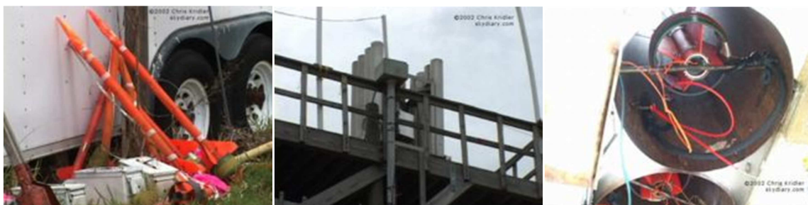
Slika 42: Prikaz pojedinih dijelova Betts-sustava iz ICLRT u Camp Blanding-u na Floridi; male rakete za iniciranje munja u oblaku (lijevo); toranj za lansiranje raketa povezan s detekcijskim uređajem (sredina); bakar-kevlar žica za povlačenje koja usmjerava munju prema zemlji. Žica isparava pa povratni udar naliči prirodnoj munji tako da se može koristiti za istraživanje (desno). [27]
