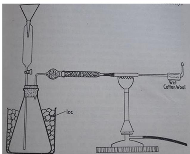
Slika 5. Aparatura za detekciju i određivanje arsena Marsh-Berzeliusovom metodom<sup>24</sup>
