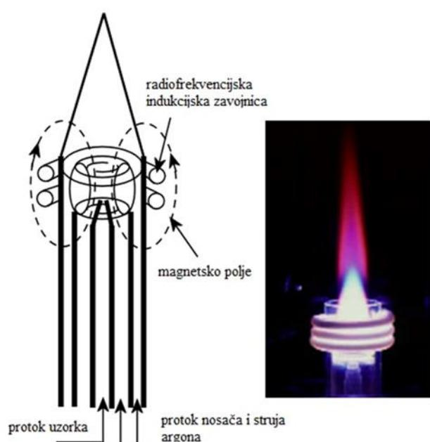
Slika 4. Induktivno spregnuti plazma izvor<sup>20</sup>
