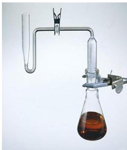
Slika 3. Aparatura za detekciju i određivanje arsena spektroskopskom metodom sa srebrovim dietilditiokarbamatom<sup>17</sup>
