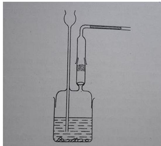
Slika 6. Aparatura za detekciju i određivanje arsena Gutzeitovom metodom<sup>24</sup>
