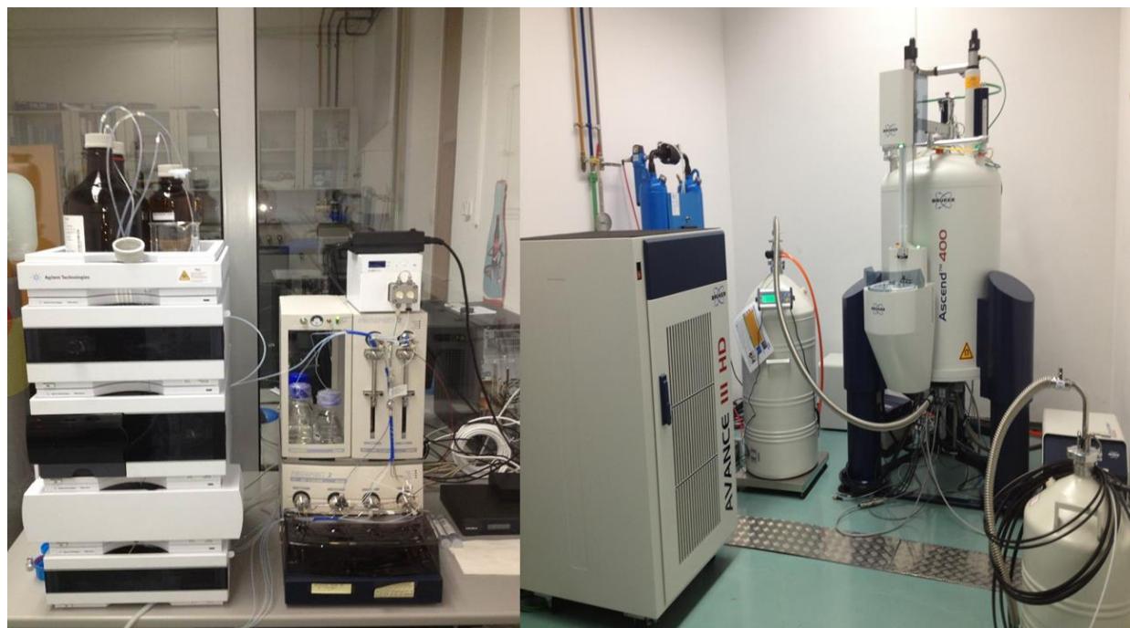
Slika 2.7.1. Vezani sustav LC-SPE/krioNMR.
