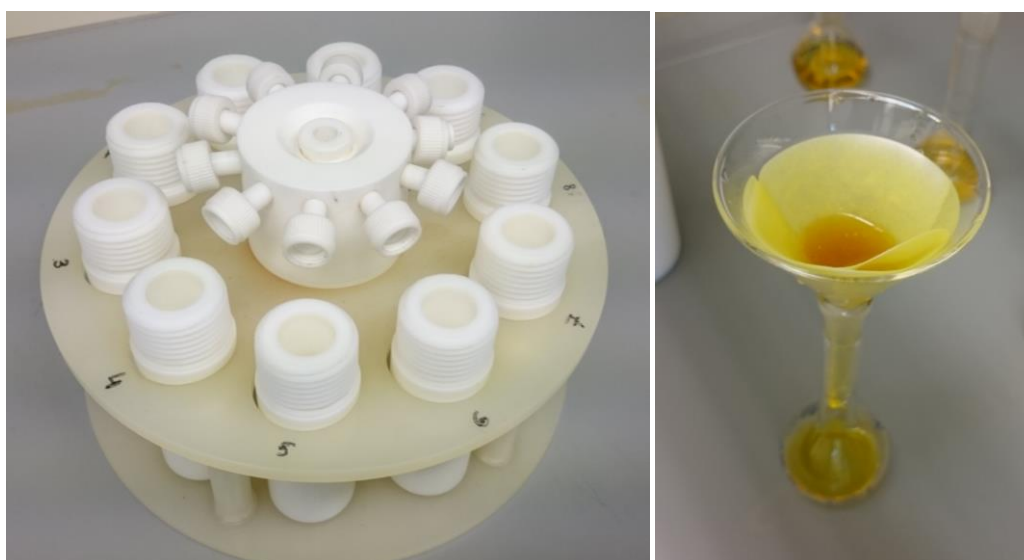
Slika 16. Prikaz kiveta (lijevo) o prikaz filtriranja preko crne vrpce (desno).
