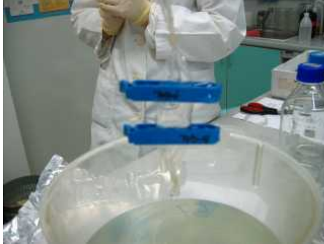
Slika 12: Prikaz membrane za dijalizu
