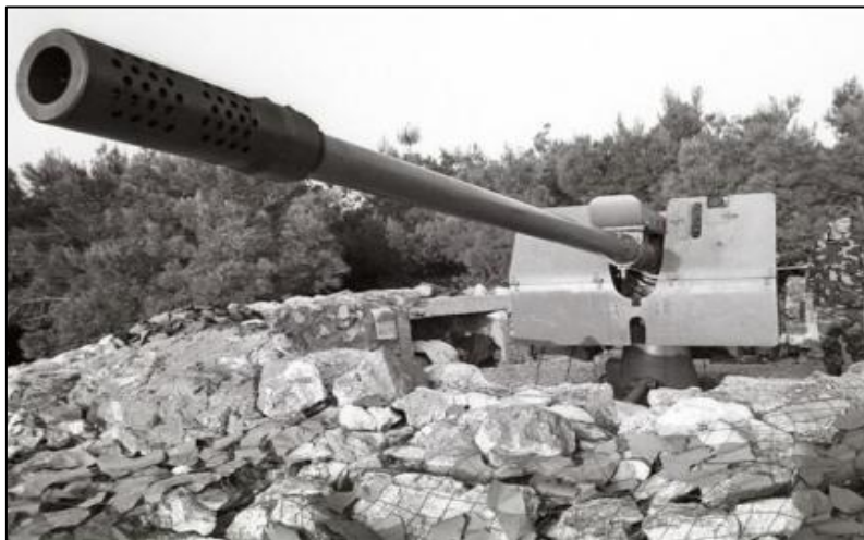
Sl. 17. Obalski top 100mm M-86, otvoreni stacionarni apasman
