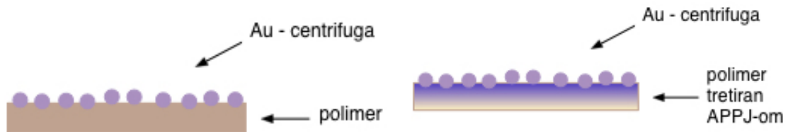
Slika 43. Shema impregnacije nanočestica na polimere za uzorke na Slici 44.
