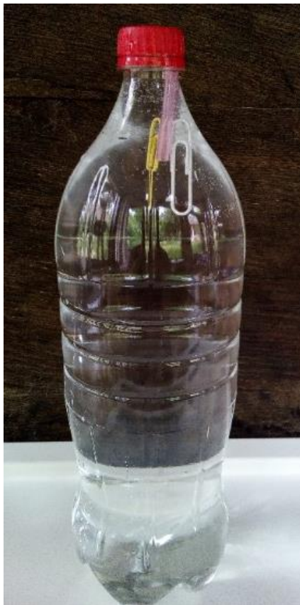
Slika 4.11. Ronilac pluta na vrhu boce.
