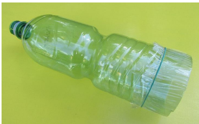
Slika 5.7. Prozirna folija preko otvora boce učvršćena gumicom.
