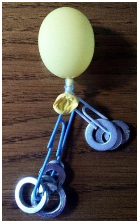
Slika 4.4. Ronilac načinjen od vodenog balona.
