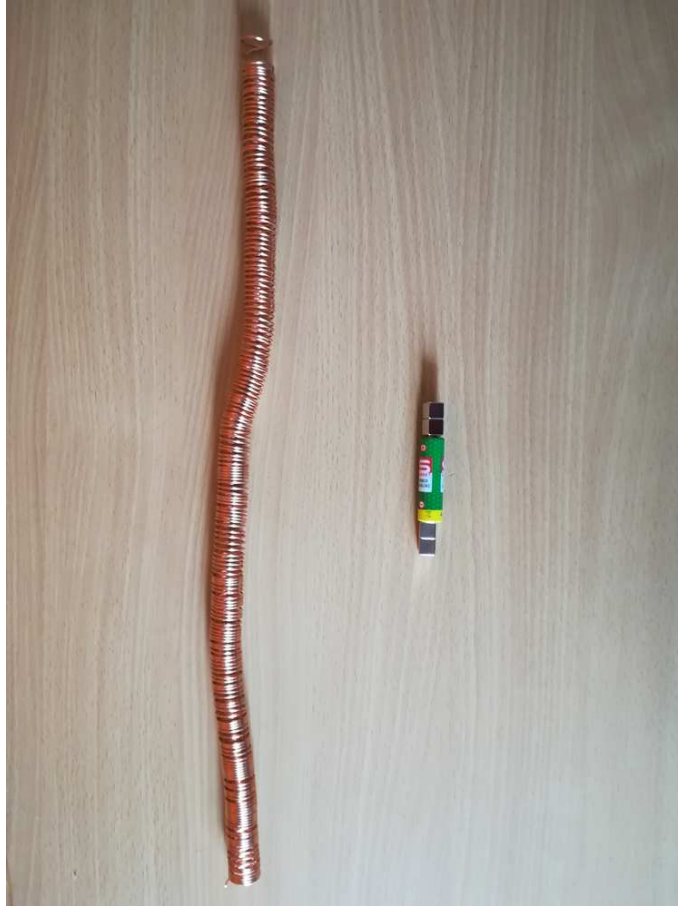
Slika 5.11: Namotana, bakrena žica i baterija s neodimijskim magnetima
