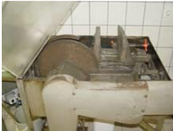
Slika 8. Pila za rezanje stijena u laboratoriju GPZ-a.
