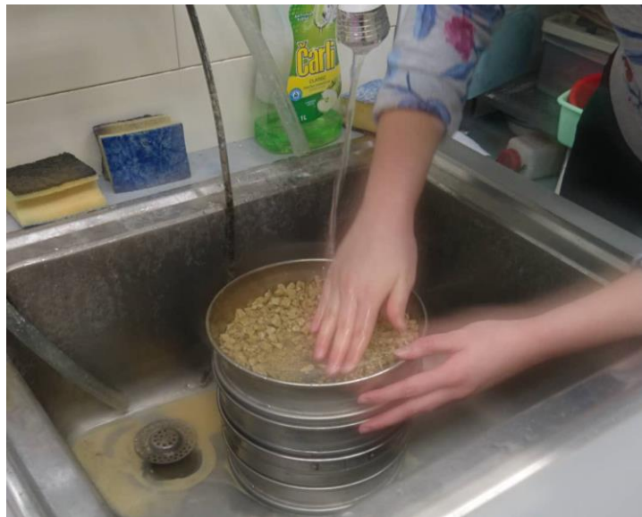
Slika 12. Prosijavanje uzorka kroz sita pod mlazom vode u laboratoriju GPZ-a.
