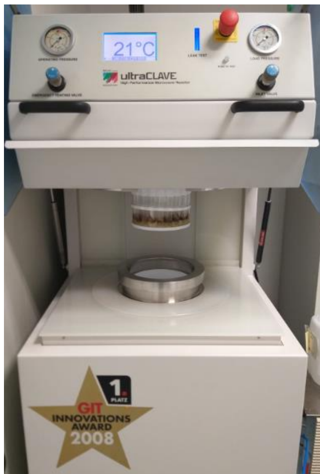
Slika 8. Uređaj za visokotlačno mikrovalno razaranje UltraCLAVE IV (Milestone, Italija).
