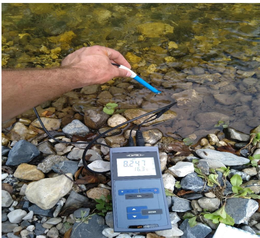
Slika 9. Mjerenje pH vrijednosti potoka sondom prijenosnog pH metra
